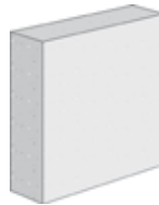
Voile béton de 16cm R_w (C; C_{tr}) = 59 (-2; -6) \text{ dB}
